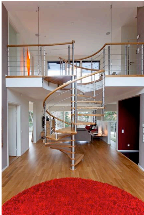
Räcke Marin. Utförande i borstat rostfritt stål. Antal medlöpare 8 mm, 4 styck. Handledare rund profil 50 mm i diameter.
