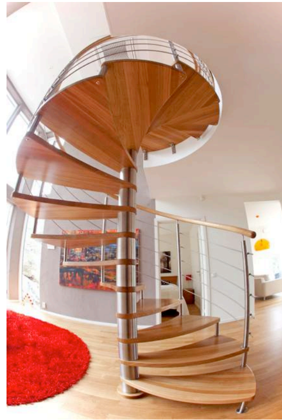
Räcke Marin. Utförande i borstat rostfritt stål. Antal medlöpare 8 mm, 4 styck. Handledare rund profil 50 mm i diameter.
