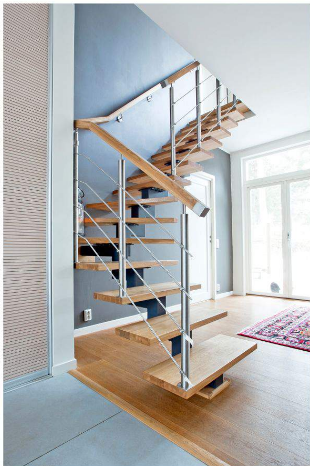
Räcke Marin. Utförande i borstat rostfritt stål. Antal medlöpare 8 mm, 4 styck. Handledare fyrkantsprofil med avslut hylsa i borstat rostfritt stål.
