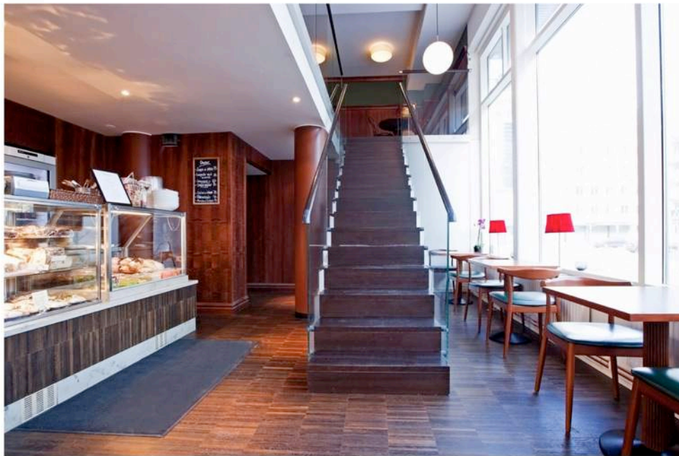
Café. Rak enbalkstrappa med underliggande balk i pulverlackat stål, RAL kulörschema. Profil balk zigzag. Sätt- & plansteg i betsad och semimatt lackad ek. Räcke i trappa samt runt bjälklagsöppning glasträcke 13 mm – härdat och laminerat. Handledare räcke rundstav 50 mm i diameter.
