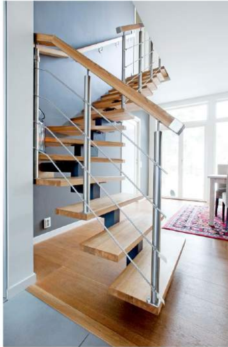
L-formad enbalkstrappa med räcke Marin. Steg i semi matt lackad ek. Underliggande balk zigzag profil, pulverlackad kulör RAL kulörschema. Handedare räcke och vägg fyrkantsprofil 50 x 50 mm.
