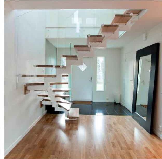
U-formad enbalkstrappa med räcke Glas 13 mm härdat och laminerat. Steg i semi matt lackad ek. Underliggande balk zigzag profil, pulverlackad kulör RAL kulörschema.
