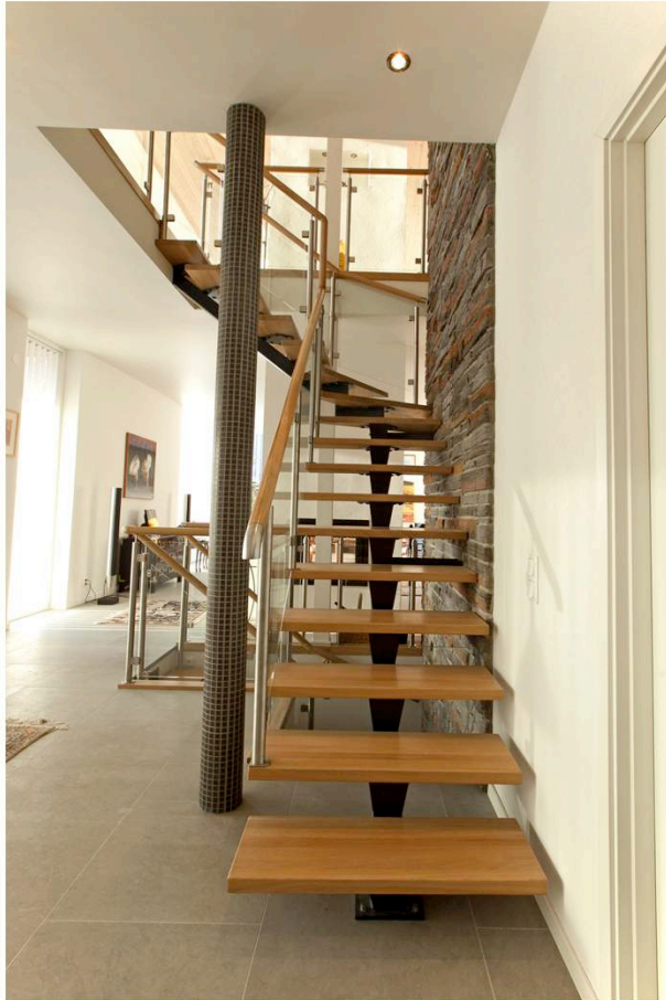
L-formad enbalkstrappa med räcke Glas 4 + 4 mm laminerat. Steg i semi matt lackad ek. Underliggande balk rak profil, pulverlackad kulör RAL kulörschema. Handledare räcke diameter 50 mm.
