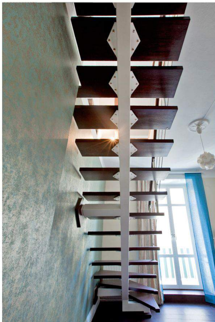
L-formad enbalkstrappa med räcke Marin i borstat rostfritt stål. Steg i betsad bok. Underliggande balk rak profil, pulverlackad kulör RAL kulörschema. Handledare räcke diameter 50 mm.
