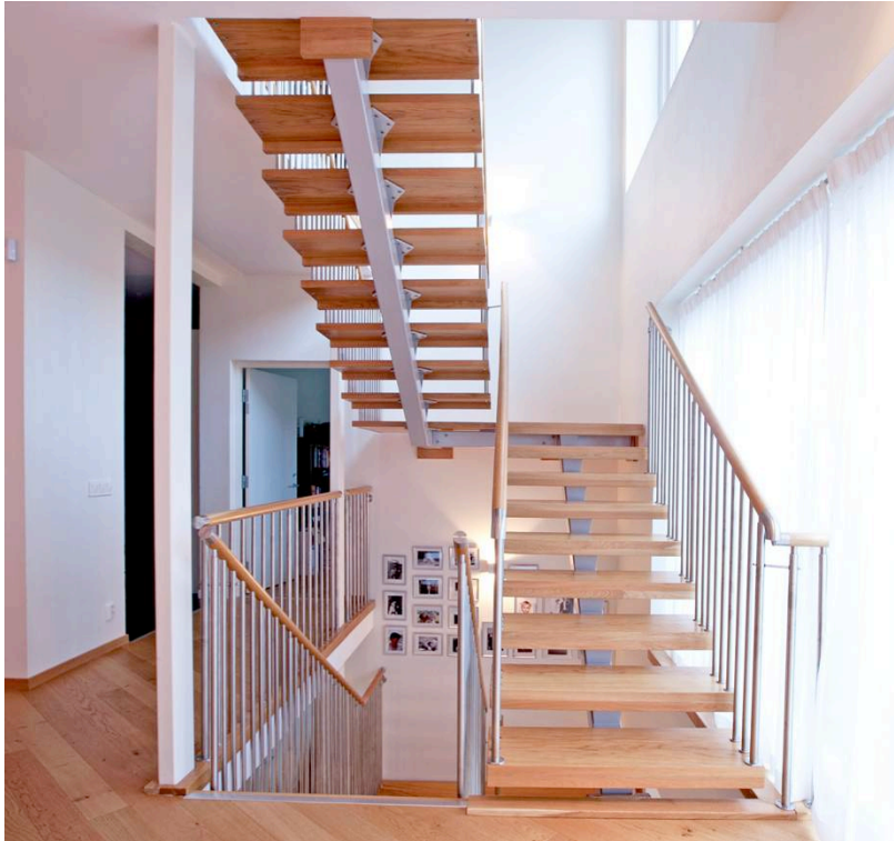
Dubbla U-formade enbalkstrappor med vilplan samt räcke Funkis i borstat rostfritt stål. Steg i semi matt lackad ek, inklusive stegnos. Underliggande balk rak profil, pulverlackad kulör RAL kulörschema. Handledare räcke diameter 50 mm.
