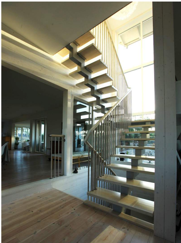
Dubbla U-formade enbalkstrappor med vilplan samt räcke Funkis i borstat rostfritt stål. Steg i vitpigmenterad ek. Underliggande balkar zigzag profil, pulverlackade kulör RAL kulörschema. Handledare räcke diameter 50 mm.
